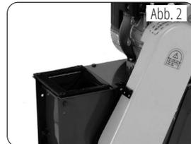
Positionierung der Einfülltrichterichtung
